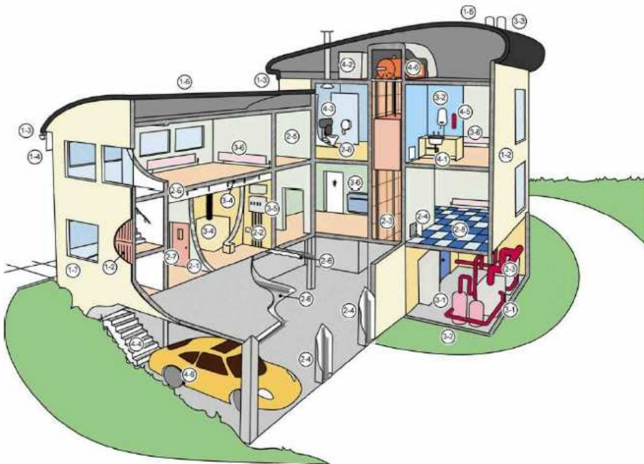
Rysunek Nr 4. Typowe lokalizacje materiałów zawierających azbest w budynku
